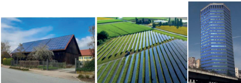
Figura 5-22 - Superfici fotovoltaiche contigue su tetto inclinato e filari fotovoltaici distanziati a terra. A destra un rendering inerente fotovoltaico in facciata capace di produrre 1GWh/anno
